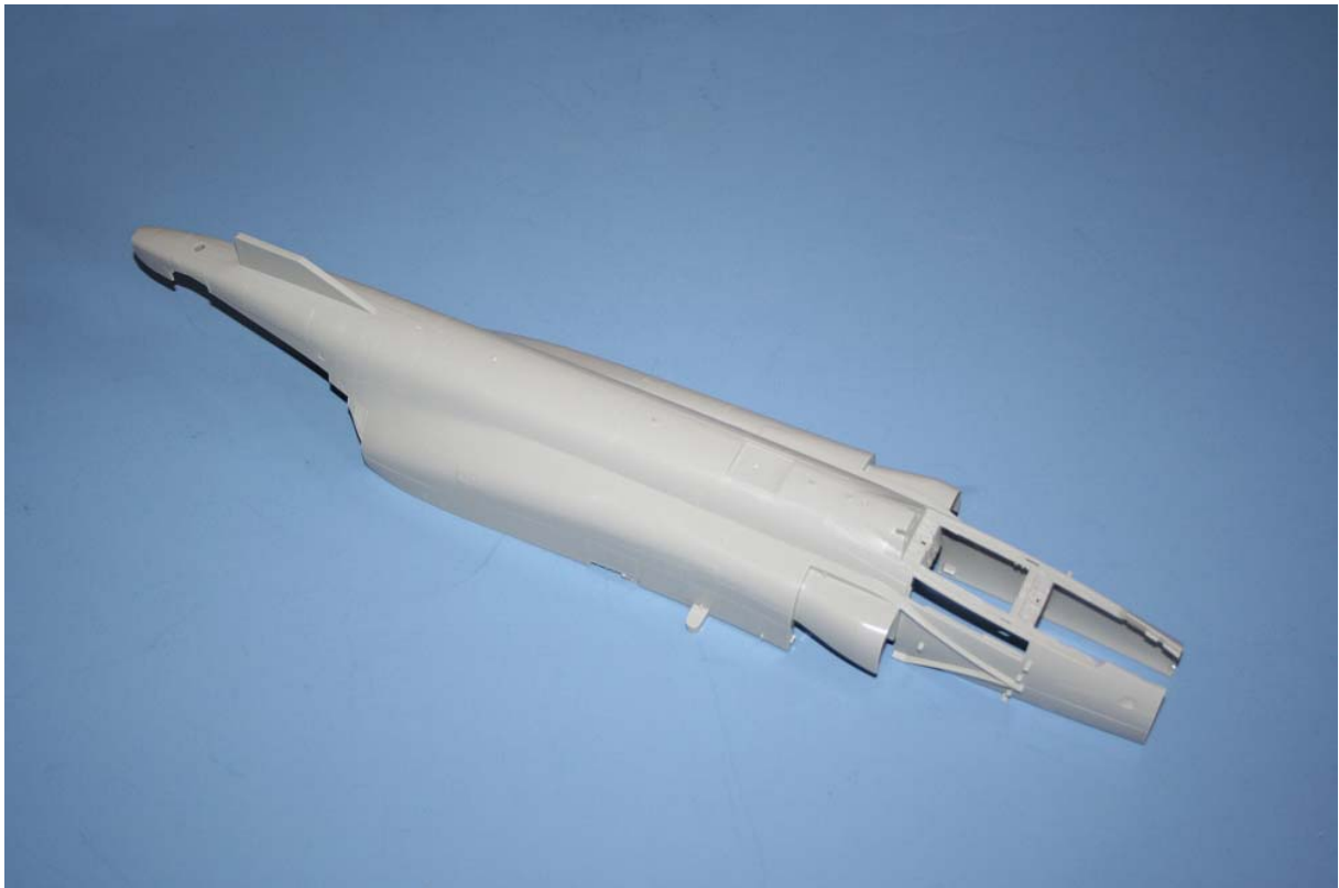
Der größte Teil des Rumpfes in einem Teil gefertigt
